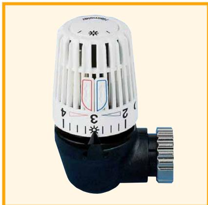
Termostatická hlavice WK je vhodná k montáži na všechna otopná tělesa typu Ventil kompak, jež jsou osazena ventilovými vložkami HEIMEIER nebo ventilovými vložkami s přípojovacím závitem termostatické hlavice M 30x1,5 jiných výrobců. Umožňuje vlastní přestavění pro montáž na levou nebo pravou stranu otopného tělesa, obě možnosti lze tedy realizovat pomocí jediného typu hlavice.
