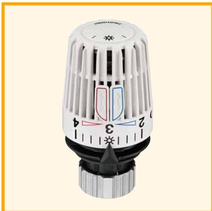
Termostatická hlavice VK se svěrným připojením je vhodná k montáži na otopná tělesa Ventil kompakt. Svěrné připojení umožňuje přímé osazení na ventilové vložky, jež nemají připojovací závit M 30x1,5. Termostatickou hlavici VK je možné montovat v několika polohách, vždy pootočených o 90°.
