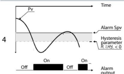
Allarme assoluto con regolatore in funzionamento freddo (Par.7  $R_{c.t.}$  selezionato  $Cool$ ) e valore di isteresi minore di "0" (Par.29  $R_{I.HY} < 0$ ).\*
