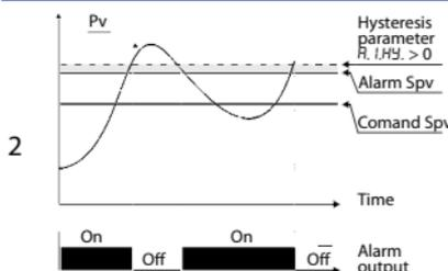
Allarme di deviazione inferiore valore di setpoint allarme minore di "0" e valore di isteresi maggiore di "0" (Par.29 R.I.H.J. > 0).\*\*
