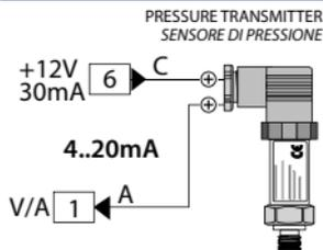
Per segnali normalizzati in corrente 0/4..20 mA con  **sensore a due fili.**
