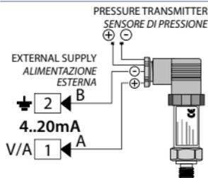
Per segnali normalizzati in corrente 0/4..20 mA con  **sensore ad alimentazione esterna.**
