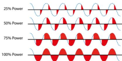
Usando un SSR no zero-crossing l'ATR227 si sincronizza con la tensione di alimentazione (necessariamente AC) e determina quando attivare l'uscita per creare la giusta parzializzazione.
