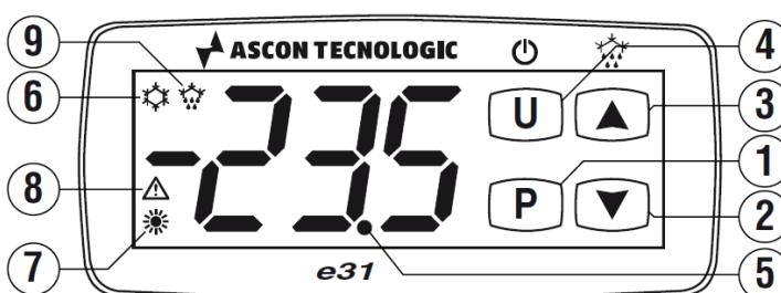
**1 - Tlačítko P :** používá se změně žádané hodnoty a k přístupu do programování parametrů (přidržte stisknuté po dobu 5 s) a k potvrzení volby. Při programování se používá pro vstup do režimu úpravy parametrů a potvrzení hodnot. Společně s tlačítkem UP lze použít pro změnu úrovně parametru. Když je klávesnice uzamčena, může být použito společně s tlačítkem UP (podržte stisknuté po dobu 5 s) pro odemknutí klávesnice.
