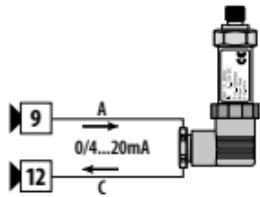
**Per segnali normalizzati in corrente 0/4..20mA con sensore a due fili**
