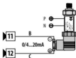
**Per segnali normalizzati in corrente 0/4..20mA con sensore ad alimentazione esterna**
