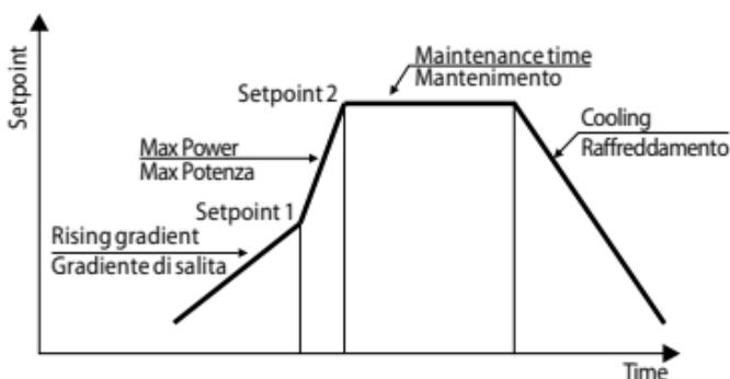
Lo Start del ciclo avviene al ogni accensione dello strumento, oppure da ingresso digitale se risulta abilitato questo tipo di funzionamento (parametro 94 *d..IF*, o 101 *d..2F* impostato come *St./St.* oppure *RuN*).
